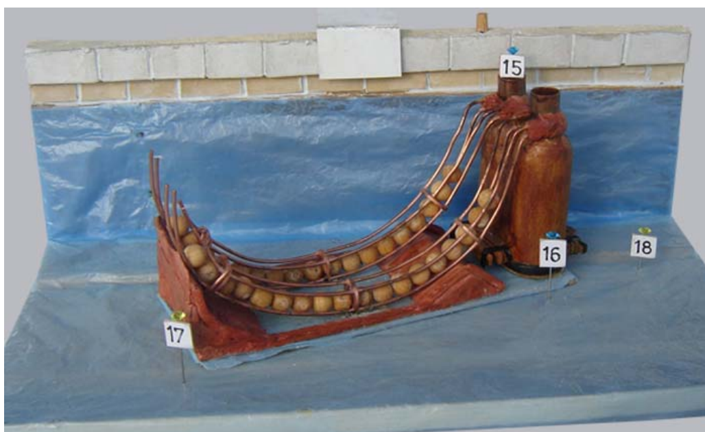
12. ábra. A félgömbhéj fedelű légharang és a golyóvezető csatornák
