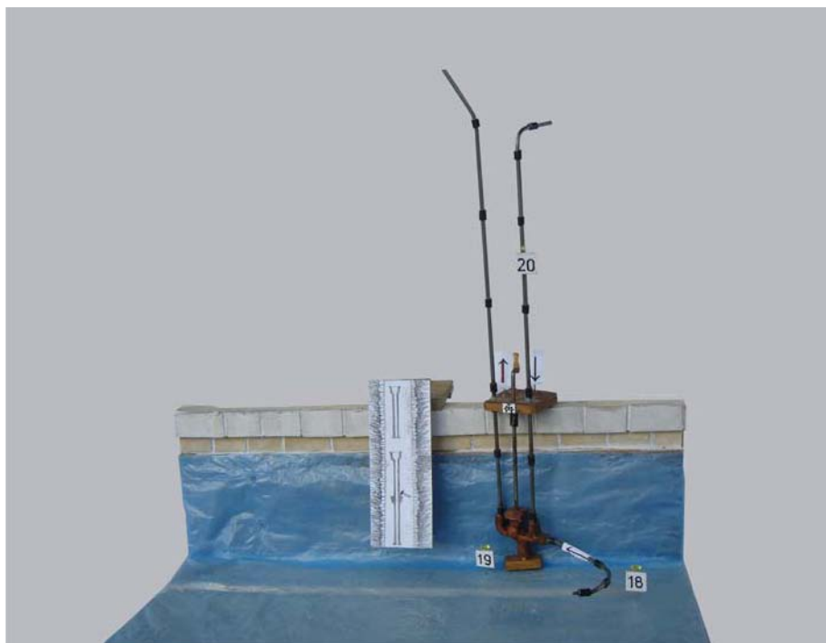
15. ábra. A víz áramlásának útja a légharang levegőztetésekor
